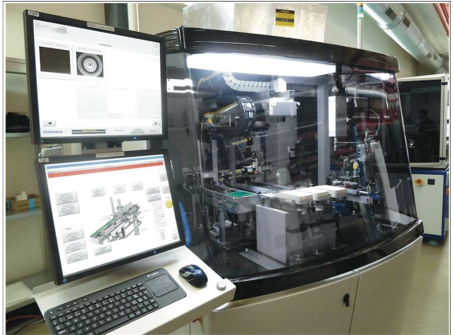
Une machine spéciale réalisée sur mesure à partir de modules standard
